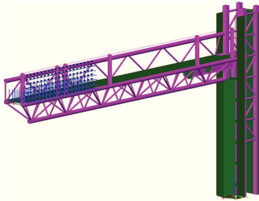
Fig. 15 – Modello di carico per l'azione di buffeting disposta in corrispondenza della 3° corsia
