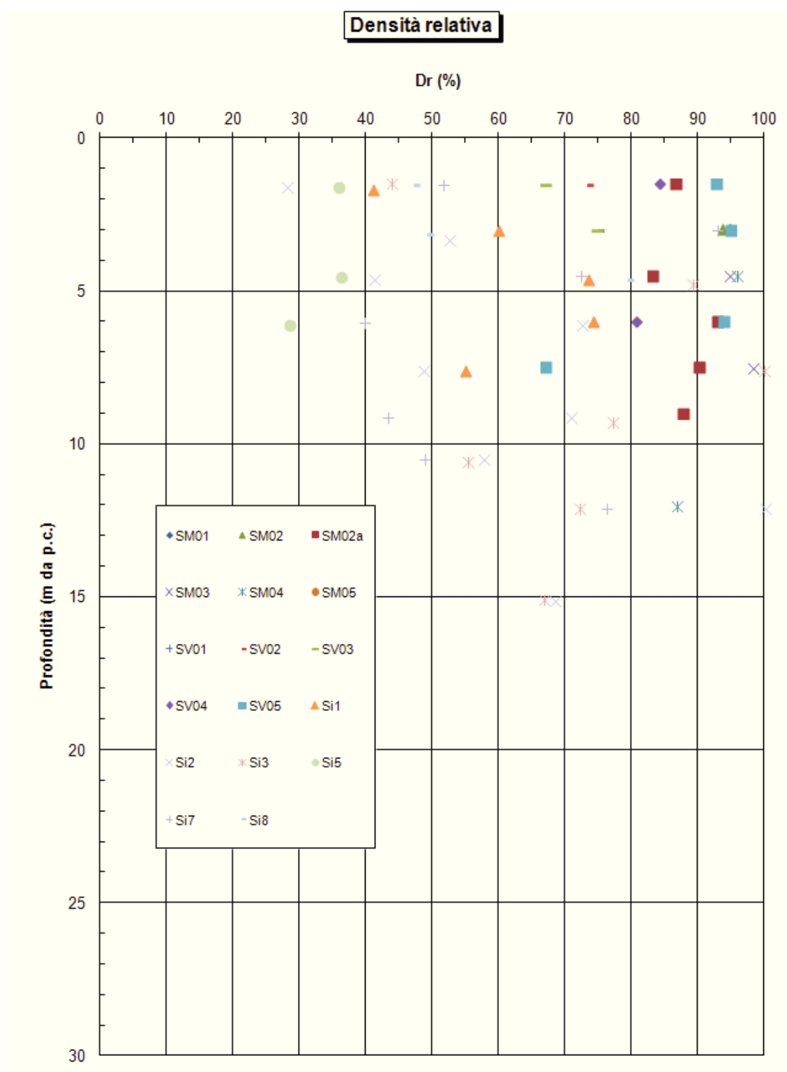
Figura 7-3: Prove penetrometriche dinamiche su unità A - Densità relativa
